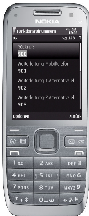
Bild 3: Bedienoberfläche für Funktionsrufnummern bei Symbian.
